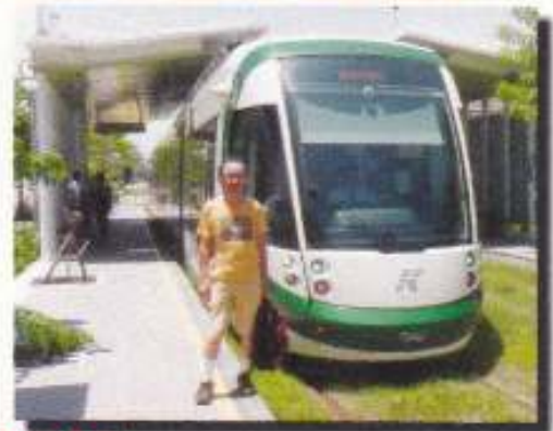
2016年6月 台湾 高雄の新交通システムに試乗 架線が無く、プラットフォームで充電して走る
