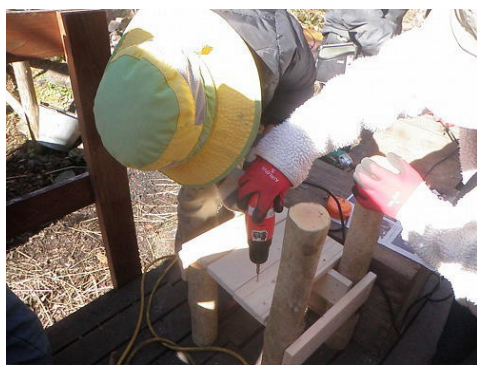
丸太と平板を電動ドライバーでビス止めしています
